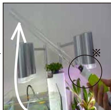
掃除が完了し、ストレーナー本体を水槽から取り出す際はノズルを水槽に這わせるようにゆっくりと上にあげながら取り出すと、ストレーナー本体内に溜まった水草の切れ端等を水槽内に落とさず、ストレーナー本体に残したまま取り出すことができます。
